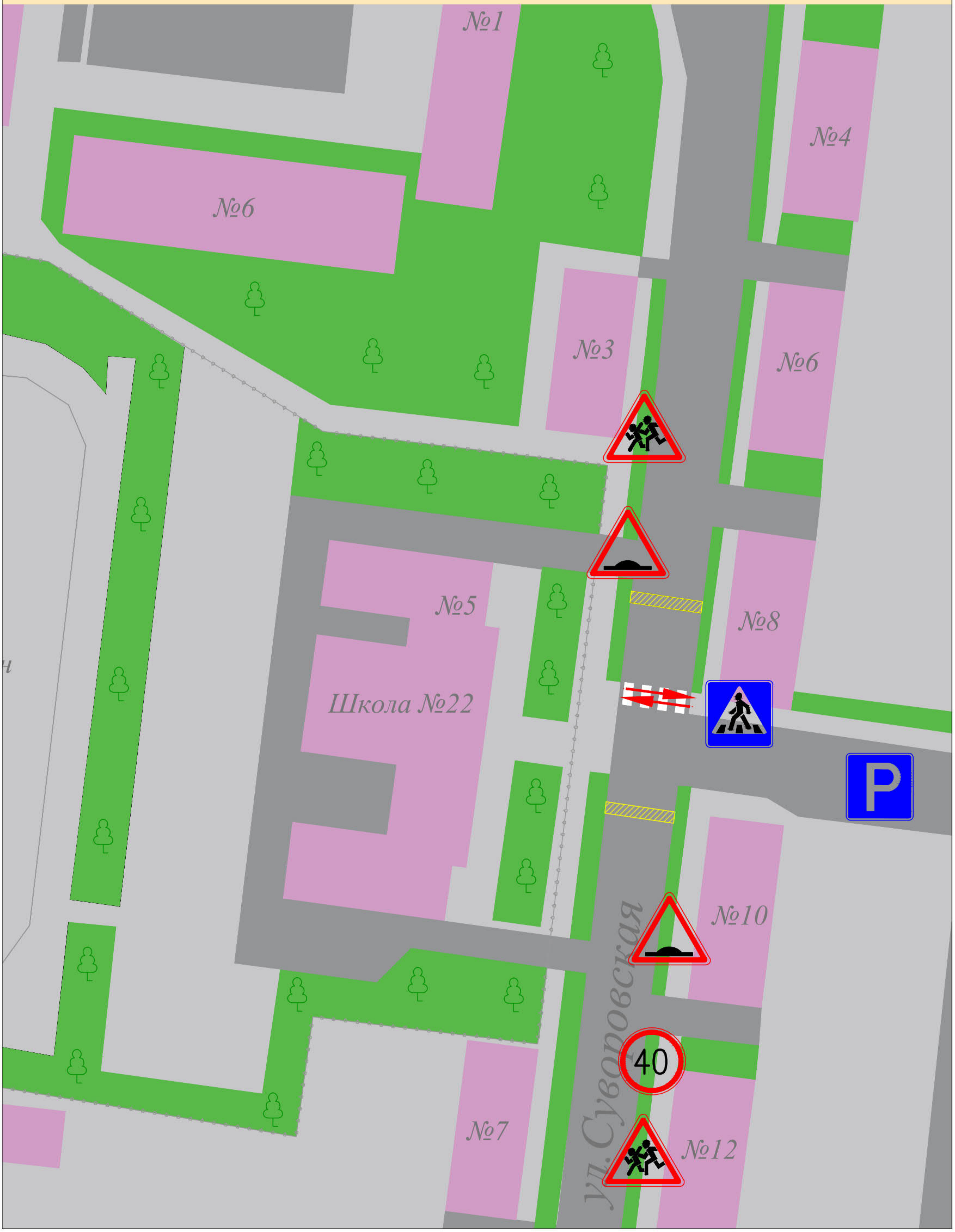
Схема организации дорожного движения в непосредственной близости от образовательного учреждения с размещением соответствующих технических средств, маршруты движения детей и расположение парковочных мест
